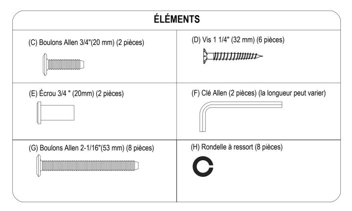
Ne serrez pas complètement tous les boulons avant que toutes les pièces ne soient en place. (veuillez ajouter un 1/2 tour supplémentaire aux boulons lors de l'utilisation de rondelle à ressort après le serrage)
